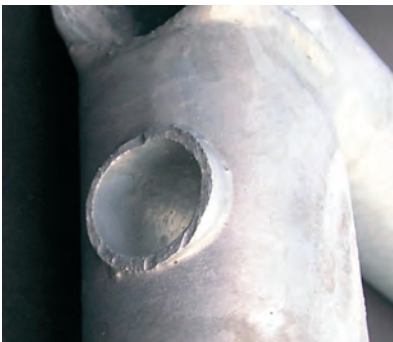
Eingeschweißte Hülse verbessert Stabilität
