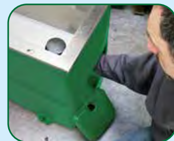
Seitliche Klappe ermöglicht einfachen Zugang zu Ablauf
