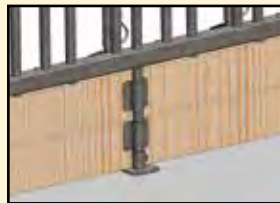
Abstützung für betonierte Barrenwand
