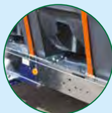
Mittels Gurt direkt am Fahrgestell befestigt
