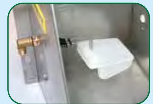
Schwimmerventil bis zu 32 l / min
