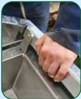
Sicherheitsschutz gg. Klemmverletzungen
