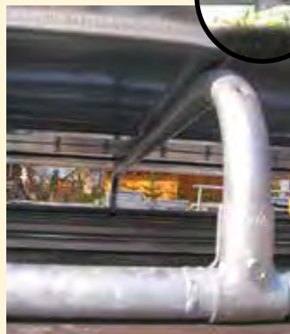
Unterzug für noch mehr Stabilität bei Verwendung schwerer Silageballen, Standard.
