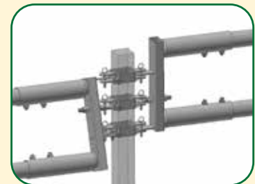
Wenden ermöglicht einfache Höhenverstellung um 15cm
